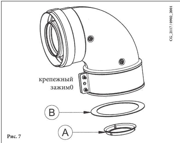
Если выход дымохода расположен снаружи, воздуховод должен выступать из стены не менее чем на 18 мм с тем, чтобы на него герметично установить алюминиевую погодную насадку во избежание попадания воды.
